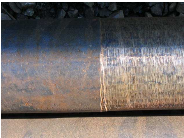
Zu stark verschliffene Oberfläche too heavy ground surface
