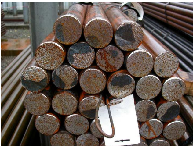
Nicht vollständig beseitigte Scherfläche not completely cleaned shearsurface at billet / bars
