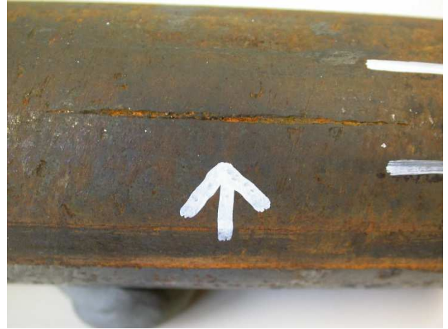
Walzriefen grooves from rolling mill
